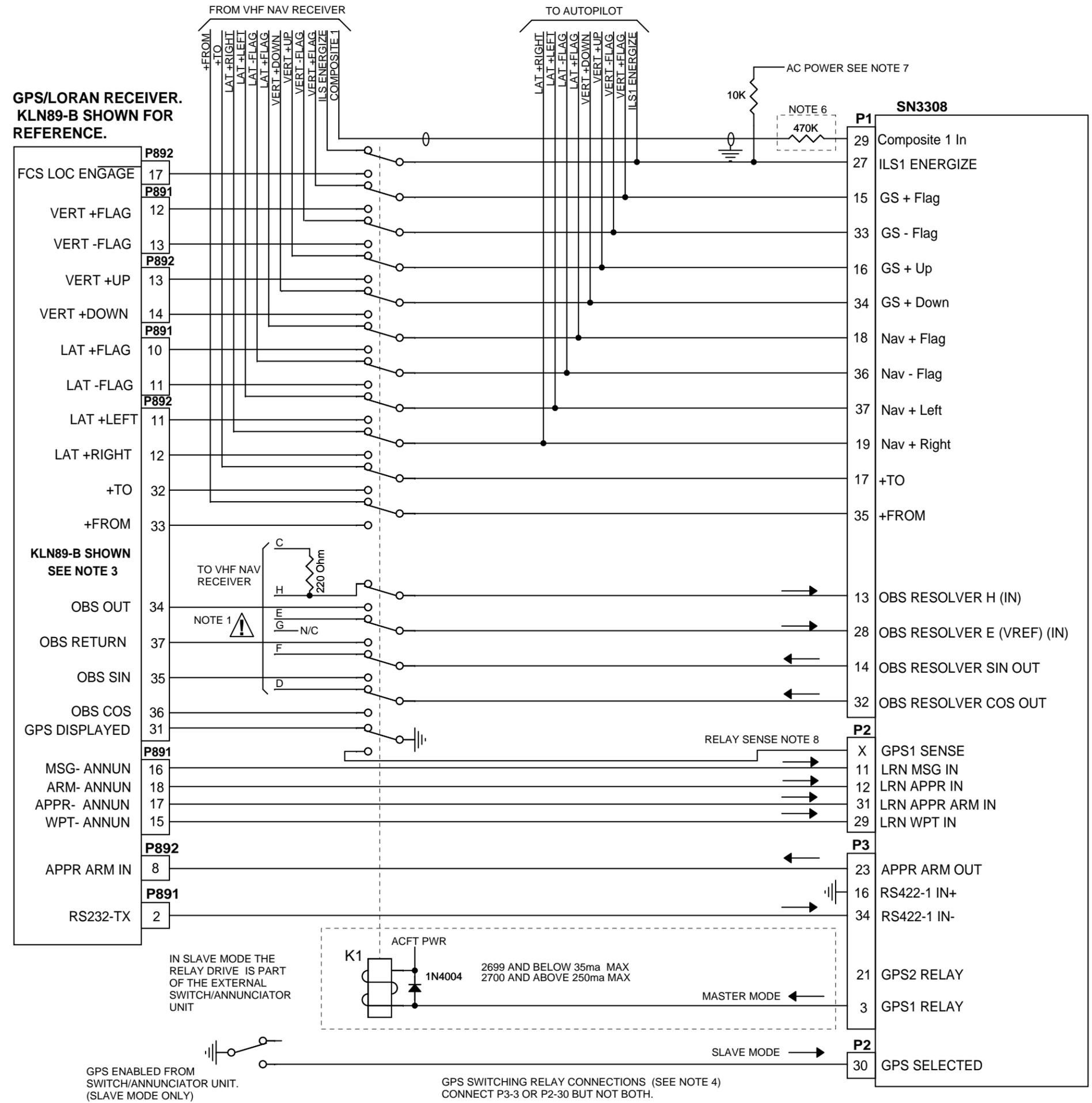
IN SLAVE MODE THE RELAY DRIVE IS PART OF THE EXTERNAL SWITCH/ANNUNCIATOR UNIT
